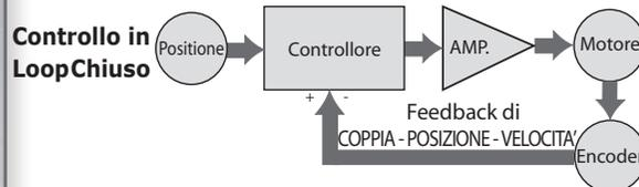
Miglior controllo rispetto ad una soluzione passo-passo in loop aperto e ad una soluzione brushless servo-controllata
