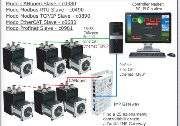
Controllo degli azionamenti tramite comandi da Controllore Master. Adatto per Sistemi Multiasse (fino a 25 azionamenti). Integra tutte le Funzionalità del Modulo Power Motion che assicura perfetta Sincronia tra gli Assi e Riduce il carico di Lavoro del Controllore Master.
