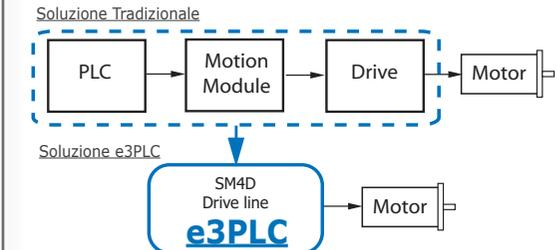
L'IDE **e3PLC** permette all'utente di accedere a tutte le funzionalità e risorse di controllo di I/O fornite dall'azionamento e di programmare localmente il suo **Modulo di Controllo del Movimento**, altresì sincronizzabile con altri azionamenti ed eventi del processo controllato. Grazie alle funzionalità avanzate del **Modulo Power Motion, Modulo di Processo Real time integrato**, si possono facilmente realizzare applicativi per applicazioni speciali quali:
