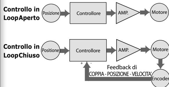
Miglior controllo rispetto ad una soluzione passo-passo in loop aperto e ad una soluzione brushless servo-controllata
